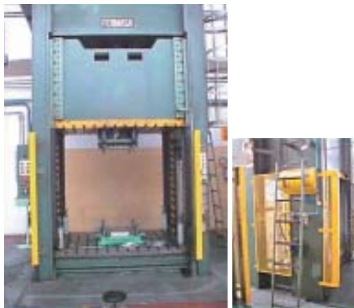
安全対策を施したプレス機
