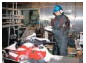
高低温環境試験室で人工降雪による雪入り凍結確認テスト
