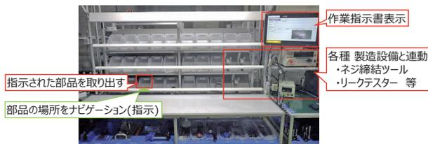
図8 実際に導入したプロジェクトアセンブリーシステムを用いた組立工程
