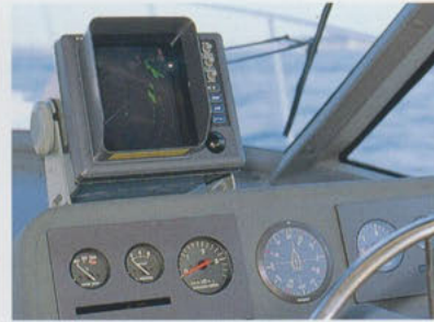
●レーダー●電子コンパス レーダーをホイールハウスに取り出す場合、干渉防止のため電子コンパスをお薦めします。
