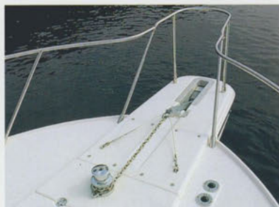
●ウインドラス 50mのアンカーチェーンがセットされています。
