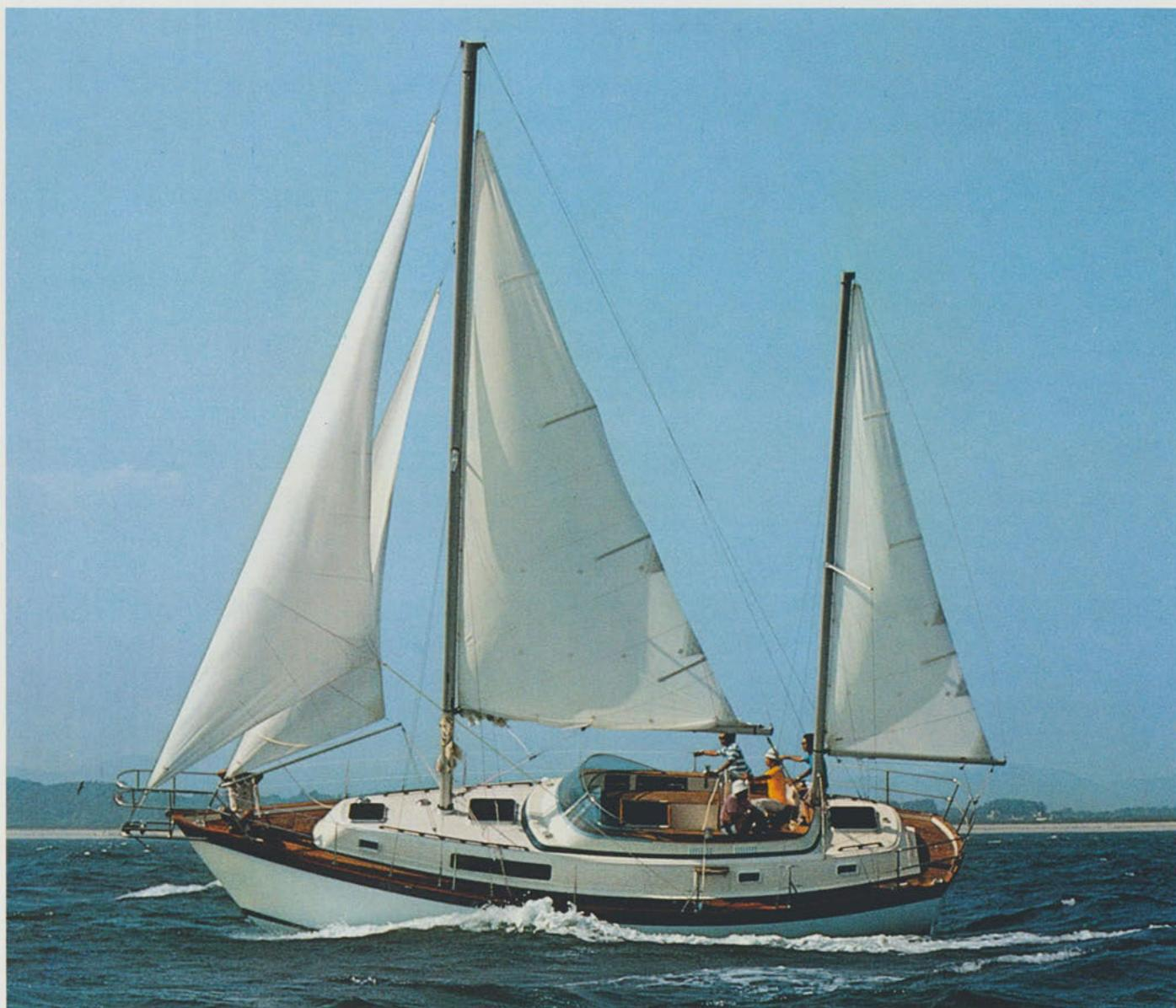
● コックピットは艇中央部に配置。操船のラクなラットステアリング(ホイール式)を中心にウィンチ類・ブロック(滑車)類・シート類を1m以内に集中しました。ここで操舵やシート操作・ウィンチ操作などが行えます。クルーワークの効率化を考慮した設計です。フロアは広く深く確保。チーク製のシートはおとな5人がゆったりとすわれます。ステアリングの前部にテーブルをセットすれば、船上パーティなどに最適なスペースになります。
