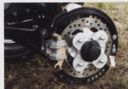
スチール製の前後ホイールには、それぞれ油圧式ディスクブレーキを装備
