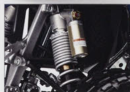
シリンダーに振動抵抗の少ないシマコーティングを施し、よりスムーズな作動性を実現したフロントショックユニット
