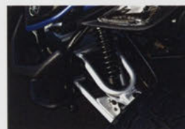
スポーティな外観と快適な乗り心地に貢献するダブルウィッシュボーンサスペンション
