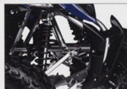
ホイールトラベルは、前200mm/後210mmを確保
