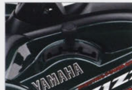
低速/高速/ニュートラル/リバース/パーキングを切り替えるシフトレバー、グリップ形状や長さなど操作性にも配慮
