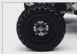
バネ下荷重を軽減する新設計アルミホイールとグリップ性に優れた新設計ラジアルタイヤ
