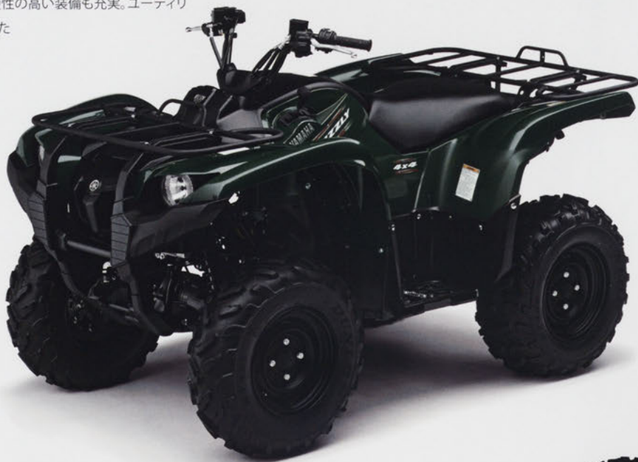
専用ショックユニットで軽量化と減衰特性の最適化をはかったダブルウィッシュボーンサスペンション。ホイールトラベルは前180mm/後230mm
