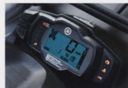
燃料計、速度計、デュアルトリップ計、エンジン連動アワーメーター、ギアポジションなどを表示するLCDデジタルメーター
