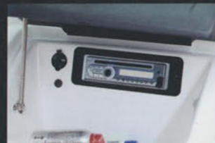
左舷ダッシュボックス/オーディオシステム* オーディオシステムをダッシュボックス内に装備しました。MP3用の入力端子も装備。
