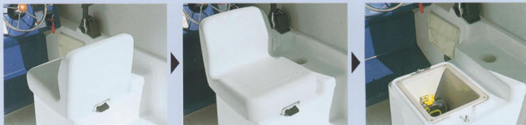
●反転式シート シートを取り外し後ろ向きにすることができます。シート下は便利な物入れになっています。(ドライバーシート、ナビゲーターシート)
