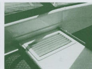
●エアコン(吹出口はバウキャビンに1カ所、メインキャビンに2カ所あります) ※発電機が必要となります。
