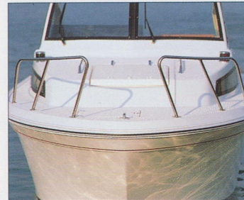
パウレール/分割式の採用により、パウデッキからの乗り降りが簡単におこなえます。
