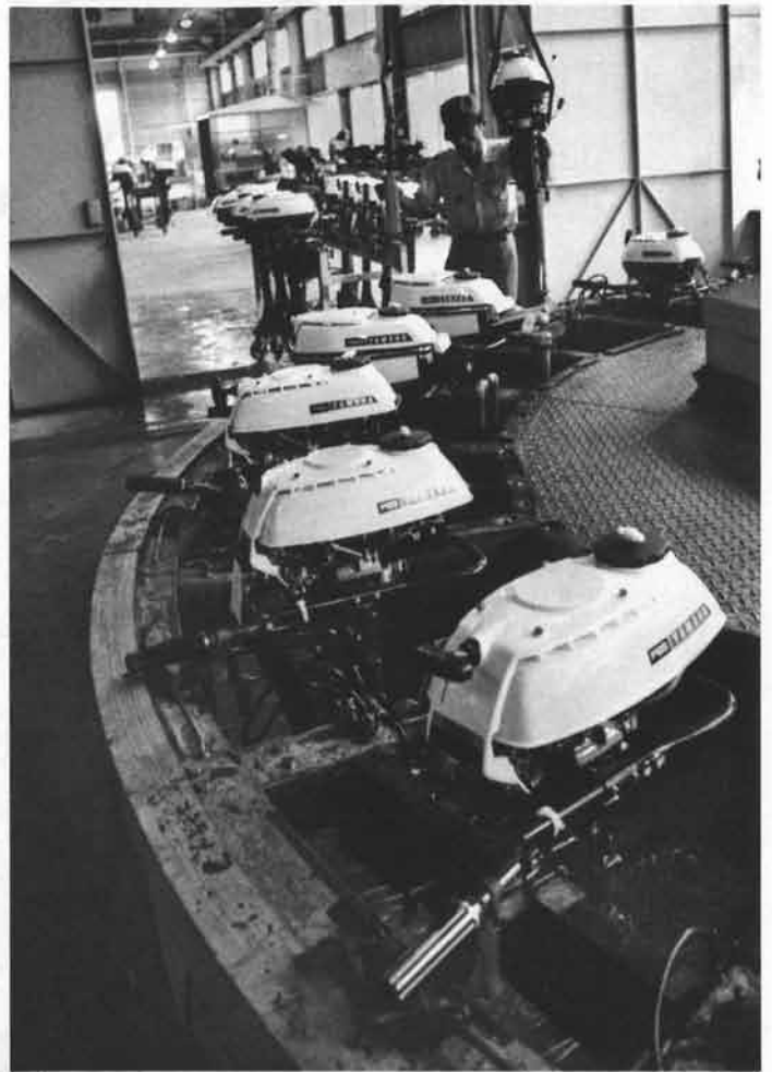
8 組付けが終了すると、最後の関門、製品検査。小排気量のは、このように回転式水槽に入れられ、20台づつフル回転が続けられる。
