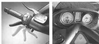
新採用のリアブレーキキャリパーと一体式パーキングブレーキ。ハンドル下のレバーを操作するだけで、確実なパーキングロックが可能
