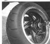
14インチから15インチにサイズアップしたリアホイールとラジアルタイヤの採用で、良好な接地感、グリップ力アップ、伝達ロス低減などで、ワインディングや高速巡行など、さまざまなシーンで高い走行性能を実現している。またアルミホイールには新デザイン5本スポーク(前後)を新採用。リム部切削とクリア塗装による美しい仕上がりで高級感がいっそうアップしている(国内仕様のみ)
