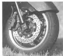
峠を果敢と攻めたいという人には欠かせない足まわりは、267mm径ダブルディスクブレーキと、41mm径テレスコピックフロントフォークを新採用。その相乗効果で、優れた操縦安定性と高いコーナリング性能を実現している
