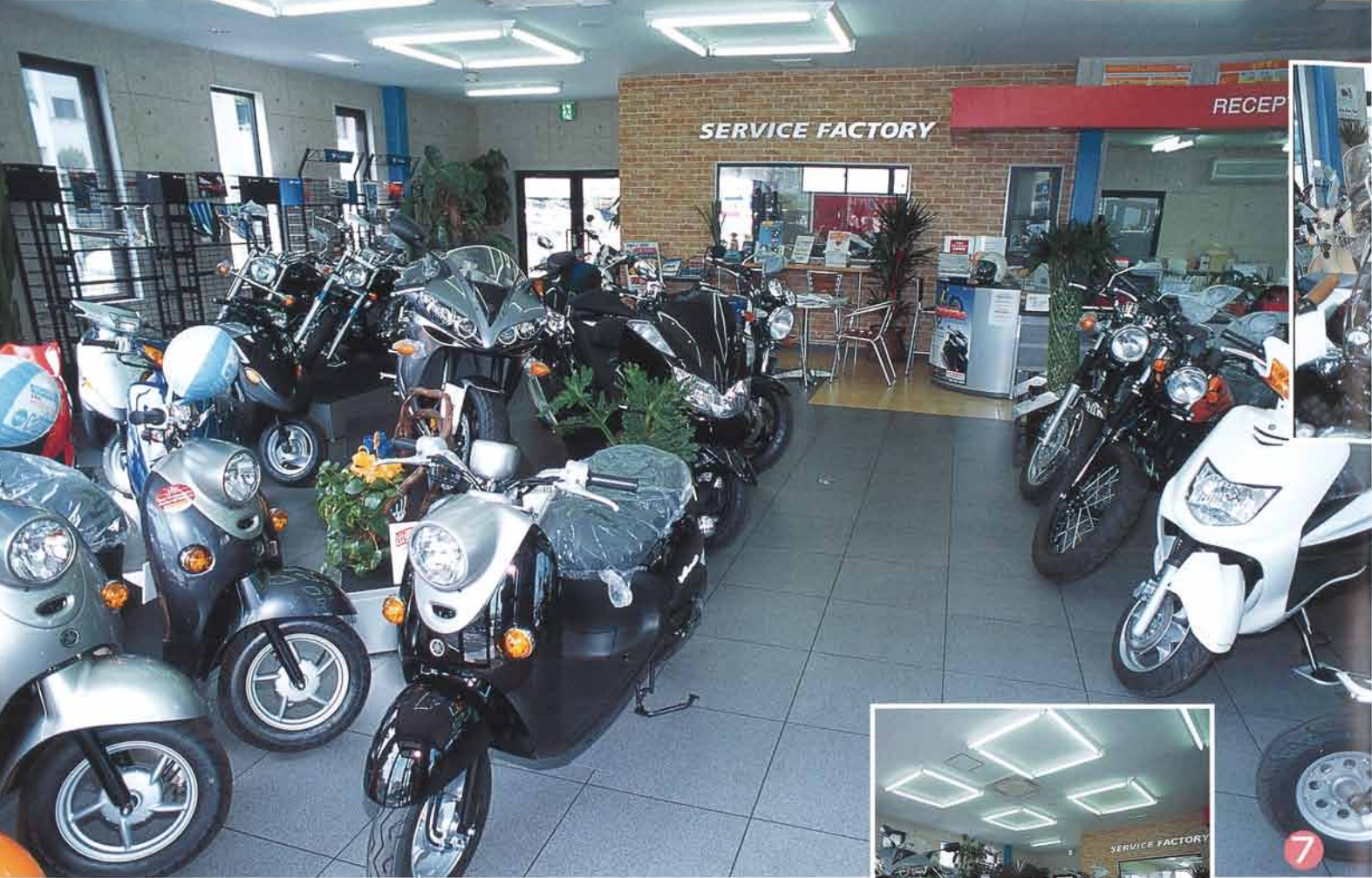
照明は光の拡散性を考えて蛍光灯を正方形に配置した
