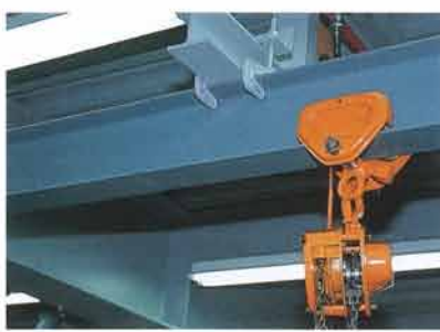
サービス工場は、数多くの蛍光灯と壁、床に淡い色を使用して明るさを重視した。またエンジンの取り外し、事故車の移動に便利なチェーンブロックを設置している
