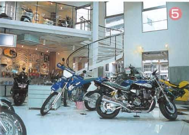
らせん階段から二階につながっている手摺の欄の部分には、一階から二階フロアの様子が見やすいように、1センチ四方の細い棒を使用している
