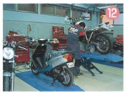
サービス工場は、数多くの蛍光灯と壁、床に淡い色を使用して明るさを重視した。またエンジンの取り外し、事故車の移動に便利なチェーンブロックを設置している
