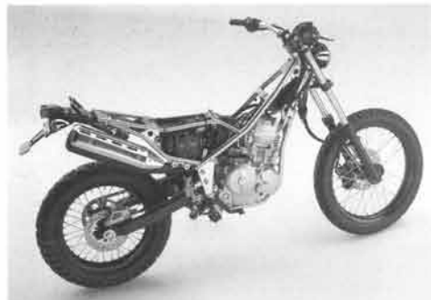
個性的な外観のポイントでもあるフレームは、軽快な操作性を実現するために新設計のセミダブルクレードル型を採用。また縦・横剛性のバランスを最適化し舗装路での優れた操縦安定性と旋回性を達成している
