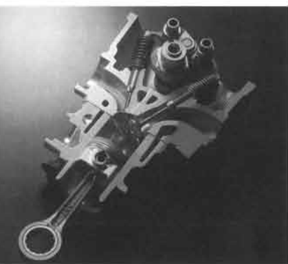
ファッションスクーターではあるが、3バルブ&メッキシリンダーなど高い技術を投入している
