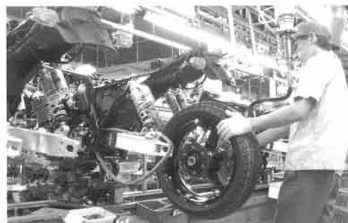
磐田第1工場内には、70~120mのラインがあり、約45~64工程を経てモーターサイクルを組み立てていく。オートメーション化が難しい工程ばかりな上、同一ライン上に多機種が流れるため、人の手が欠かせない
