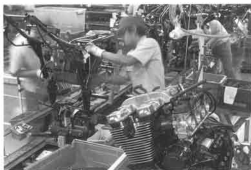
磐田第1工場内には、70~120mのラインがあり、約45~64工程を経てモーターサイクルを組み立てていく。オートメーション化が難しい工程ばかりな上、同一ライン上に多機種が流れるため、人の手が欠かせない
