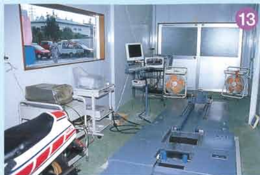
サービス工場脇にはシャーシダイナモが導入されており、いつでもパワーチェックできるようになっている
