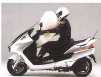
前面衝突の衝撃を緩和するエアバッグシステム
