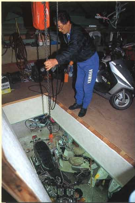
2階の倉庫へは、1階ショールームの天井を通してウインチでバイクを引き上げる。最大1トンまで持ち上げることが可能だ
