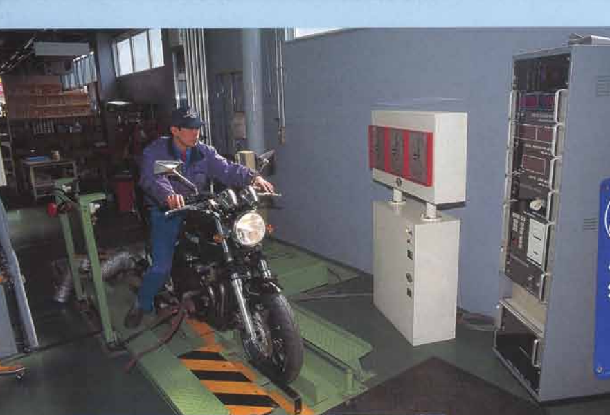
ダイナモの設備は車検だけでなく、通常の整備でも力を発揮する。整備の様子はガラス越しにショールームから見学できる
