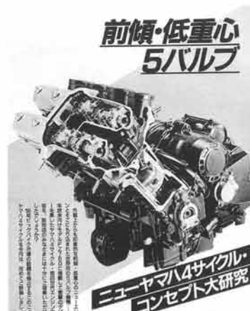
最高出力77ps/9500rpm、最大トルク7.0kg-m/6500rpmを誇る直4・5バルブエンジン ('84/12)
