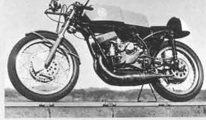
RD56 1962年の初登場以来、世界の舞台で活躍したマシン。ロータリーバルブ吸気、オートループ搭載の249.7ccエンジンは45ps/11,000rpmと言われる
