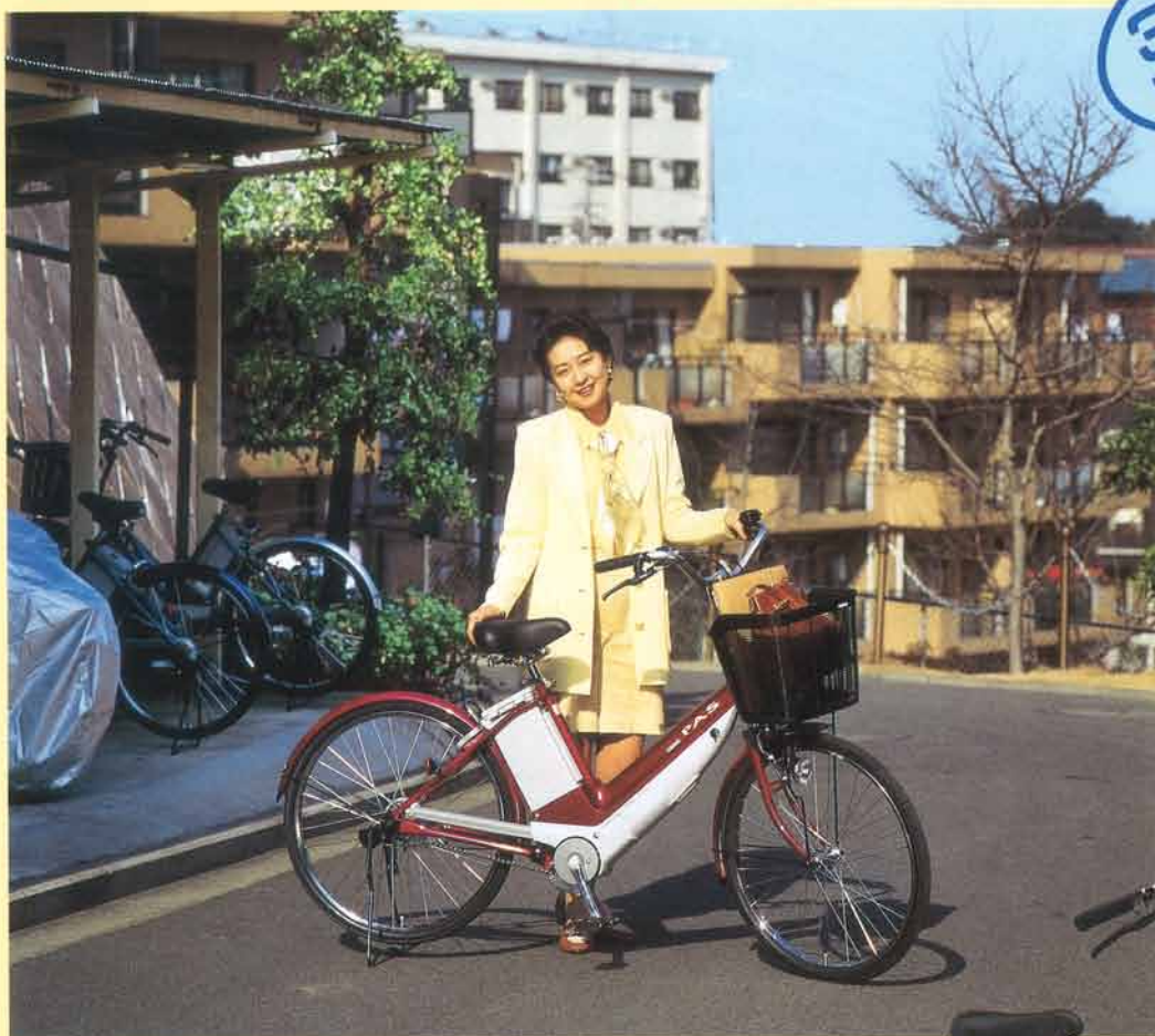
着脱が容易。アパート、マンションの家庭用電源から専用チャージャーで充電できるニカド式バッテリー
