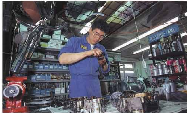
サービス工場内の作業台の天井は鉄の棒で組まれた棚。置くことも、つるすこともできる
