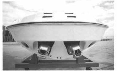
ジェット推進システムは、船底の給水口から水を吸い上げ、エンジンと直結した推進機のインペラ(回転ポンプ)で水を加圧し船尾のノズルから噴射し推進力を得る
