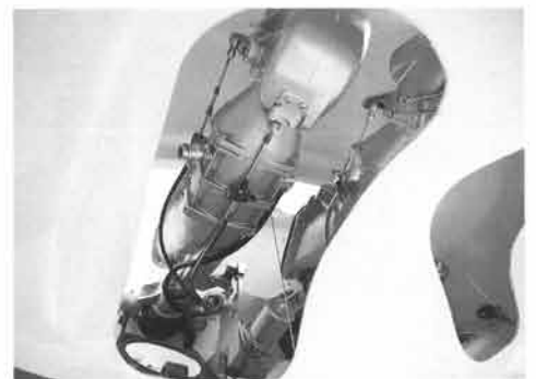
推進ユニットは、チルト&ロールの2ウェイ可動式として、給水口の点検が船内から行なえ、万が一のゴミづまりに対処しやすくなっている
