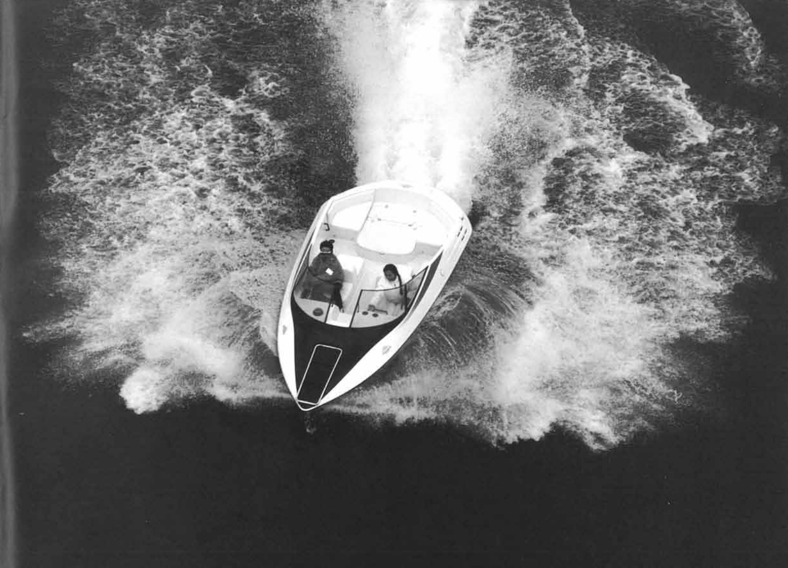
ブレーキング(滑走)状態でリバースバスケットを覆い逆噴射をかけて急停止。 通常のスロットルを戻した停止よりも距離が格段に短くなる
