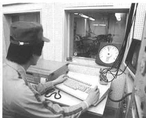
ベンチテストのエンジンコントロールは、すべてリモートで行なわれる
