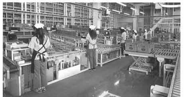
協会社社から納入されたエンジンパーツは、コードナンバーで区分され、ロータリーラックに収納される
