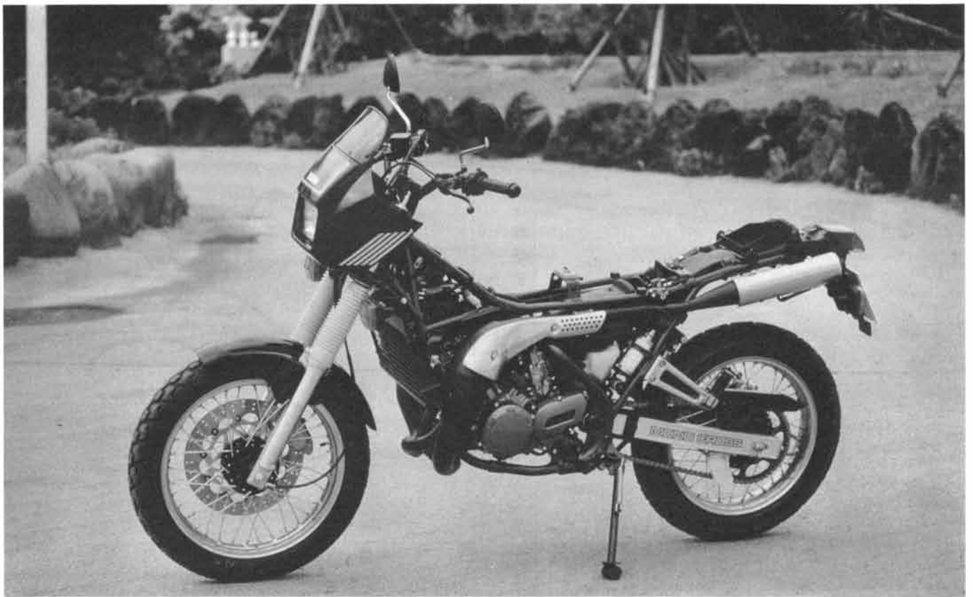
高張力鋼管ダブル クレードルフレーム
