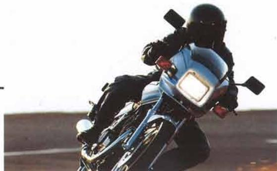
**D**OHC、パラレルツインのY.I.C.S.エンジンは、圧縮比のアップ、パワーロスの低減、2段進角式フルトランジスタ点火の採用により3馬力アップの33P S / 10500rpmを発揮。同時にリッター50kmという低燃費を実現しました。とくに、中低速レスポンスを一段と向上させたパワー特性は、2次減速比の変更とあいまって、ツーリングモデルとして理想的な、扱いやすさとなっています。
