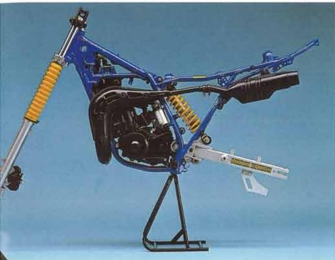
30 P S ・ クラス最強のパワーを生み出す水冷 ・ 2 サイクルを、軽量 ・ 高剛性の高張力鋼管セミダブルクレードル ・ フレームに搭載。240mm のロングホイールトラベルを持つセミエアタイプのフロントフォークは、D U メタル装備で減衰力 3 段階調整式。定評のニューリンク式モノクロスサスペンションは、アルミリアアーム装備。減衰力 5 段階調整付。
