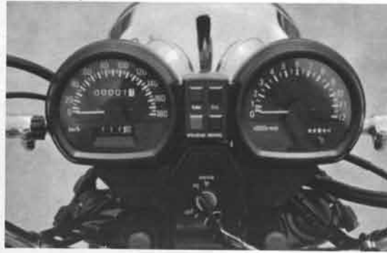
ニューデザインの見やすい透過光式傾斜メーターパネル
