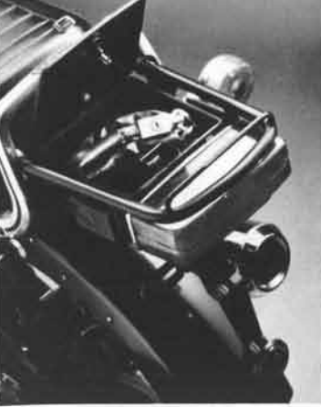
リアエンドに設けた便利なキャリングスペース下のキー付小物入れ。この中には盗難防止用のチェーンロックが収納されている
