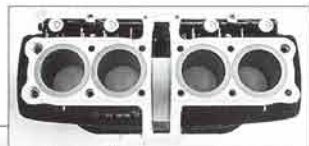
写真は、ニューXJのシリンダー(右)とシリンダーヘッド。燃焼室とシリンダーポート上部に見える
