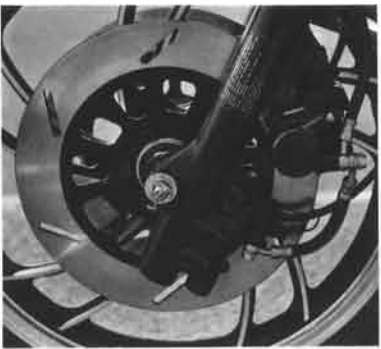
XJ750Aのエアフロントフォークにはヤマハ独自のアジャスタブル・アンチノーズタイプ機構も備えて安全性、快適性をアップ
