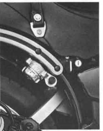
初採用の「エアモノサス」は、モノクロスサスペンションの構造を調整できる。写真のダイヤルは、シート右下に設置されている。
