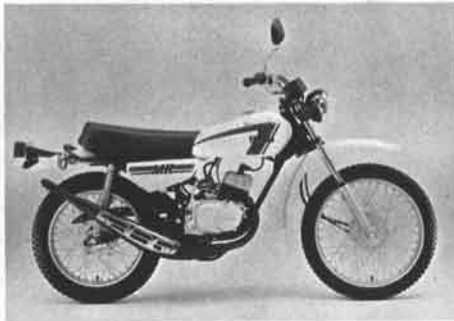
MR50：'77年2月発売。タンク、サイドカバー、フェンダー関係を変更。タイヤも変更されてより一段とトレール性能をアップ。
