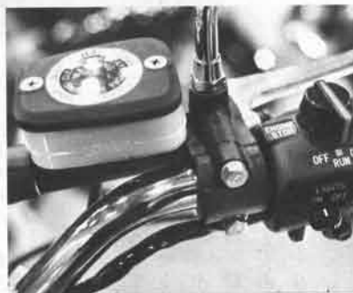
透明で角型となったマスターシリンダーをもつ右グリップ部
