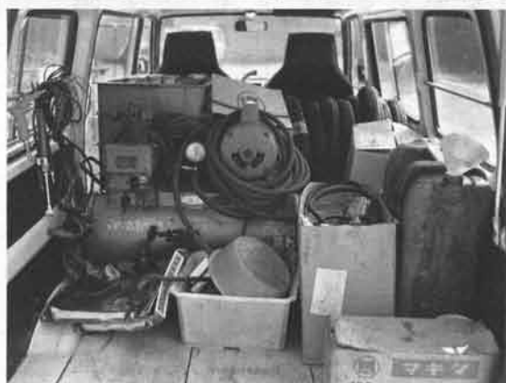
▲点検整備で調子も最高、さらに布ぶきをしてメイトは見ちがえるほどきれいに。お客さまの信頼もグンと変わってくる ▲訪問サービスカーの中には、細かいパーツからコンプレッサまである。特にメイトに関する部品はほとんど備えてある
