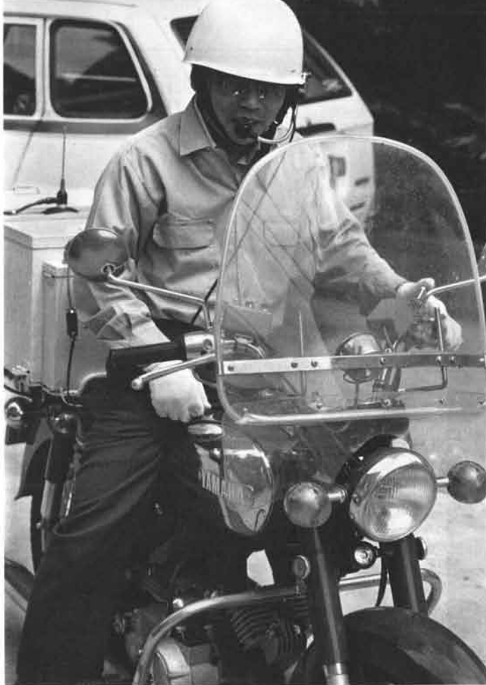
ハンドル左手のボックスにある送信レバーを押して本部との連絡。もちろん走りながらも送信できる。
