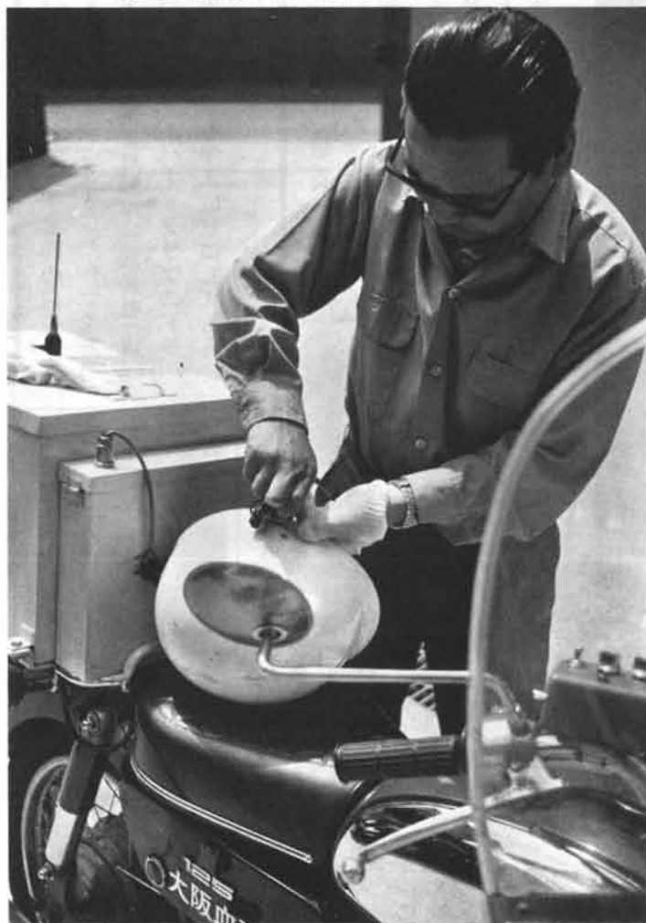
ハンドル左手のボックスにある送信レバーを押して本部との連絡。もちろん走りながらも送信できる。
