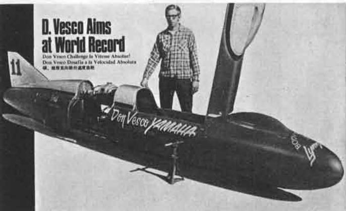
'70年秋、市販レーサー\*TR2-B\*のエンジンを前後に2基つけた700cc4気筒の速度記録作成車。ライダーはむろんドン・ベスコ氏で、このときは時速265.49マイル⇔427.17km/hを達成して、みごとレコード・ホルダーとなった。この記録は間もなく倍の大きさエンジンをもったC・レイボーンのハーレーに破られ、今度の再挑戦となったものである
