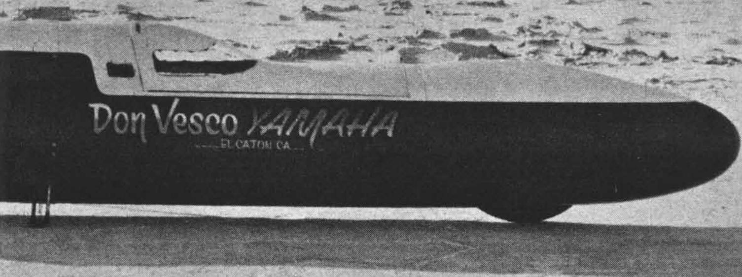
時速453.277km/ 軽飛行機も追いつかぬ速度記録を達成したこのマシンは、全長20フィート8インチ≒6m24cm、重量750ポンド≒327kg、制作費は2万5000ドルを要した
