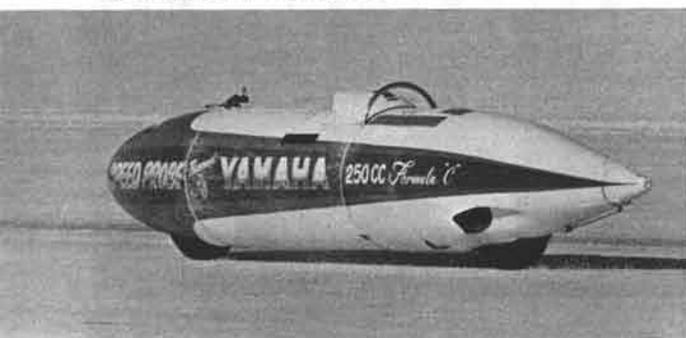
'65年秋、フォーミュラーC=250cc級で280km/hの最高速度記録樹立したマシンも、エンジンはヤマハで、かの有名なワークスレーサーRD56のものを使用した
