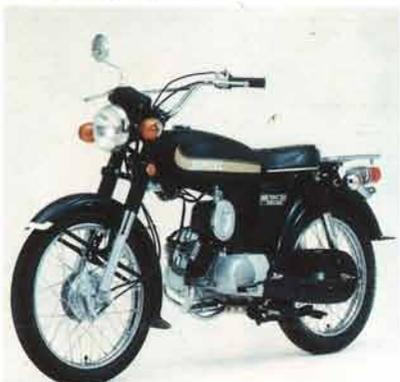
いちやく合理的な設計の7ボーンフレームを採用し、整備性のよさでも定評を得ているのがこのYB90である。軽量な車体に、ゆとりあるパワーのロータリーバルブ式2サイクルを採用、あらゆる用途に巾広く使えるものとしている。
