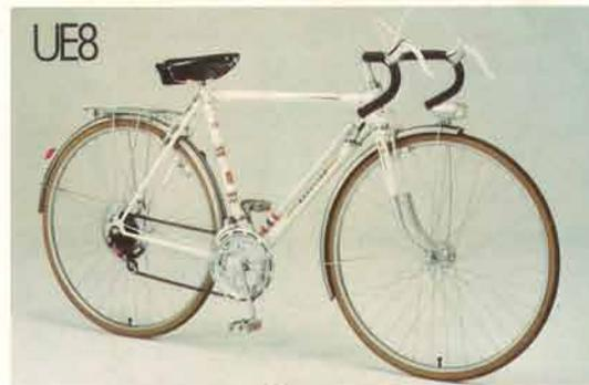
●外装10段サンブレックス製パンダグラフ式 (フランタ: 50-40T, フリー: 14-17-20-24-28T) ●マフアック製センタープルキャリパーブレーキ ●フレーム・リム・タイヤ (21-27×1 1/4) ●ベントラックス製アルミインフレター、マフアック補修キット入りツールバッグ
