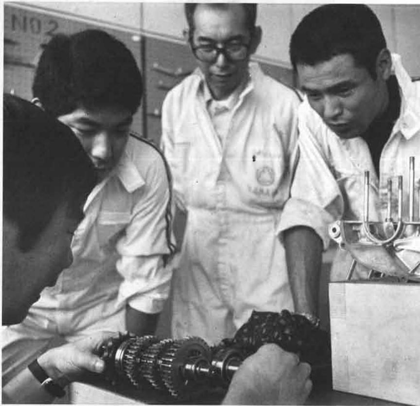
ミッションギヤのかみ合い状態、損傷の有無、動力の伝達経路等を点検し、作動を確認する。
