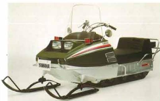
非対称山高バターンのトラックを採用。さらに有効にパワーを生かすものとしている。サイレンサー空気取入口も改良。
