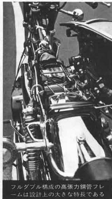
フルダブル構成の高張力鋼管フレームは設計上の大きな特長である
