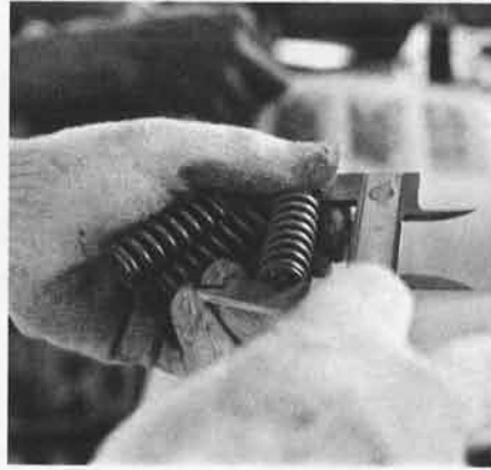
バルブスプリング自由長の測定
