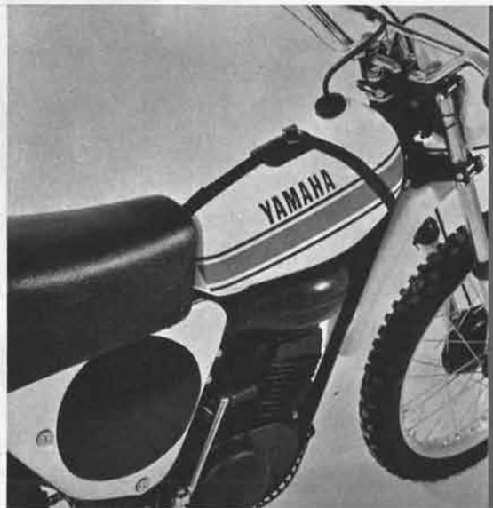
アルミ製の燃料タンクはベルトサポート方式。車体側面は非常にスリムにまとめられ、自在なライディングポジションがとれるものとなっている。
