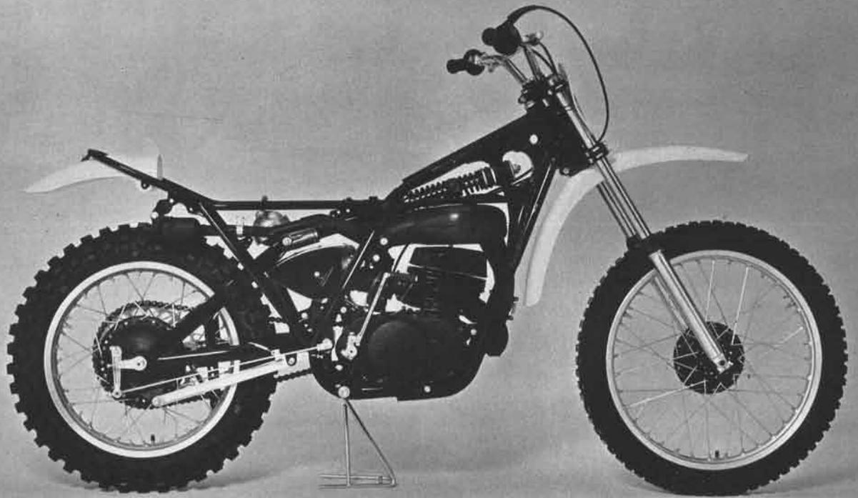
高圧ガス+油圧+コイルスプリング+緩衝ゴムの4段階構造でショックを吸収するヤマハモノクロクロスサスペンションのクツシヨンユニットはヤマハ製。コイルスプリングは標準仕様のほかに強弱2本のもが用意されている。
