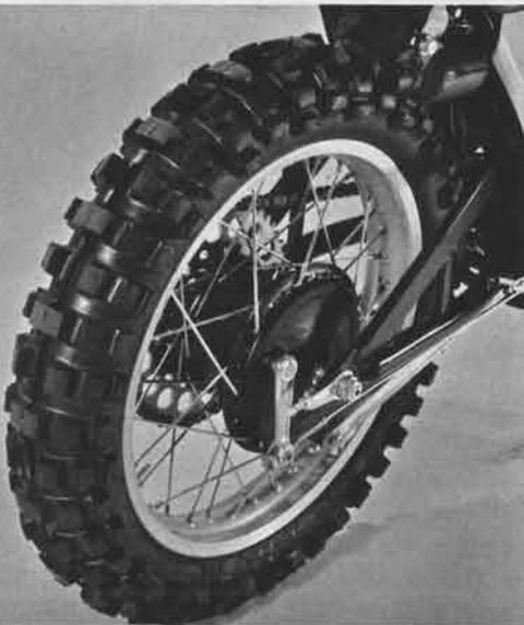
ヤマハモノクロクロスサスペンションと相まって確実なロードグリップを生み出すリヤの四・六〇—十八のダンロップスポーツセニア。リムは前後ともアルミ製で泥はけのよいE型。
