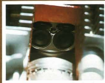
排気側から見た燃焼室。1気筒に4つのバルブを配置した燃焼室形状はヤマハ独自のペントループ型で理想的な吸排気を行なう
