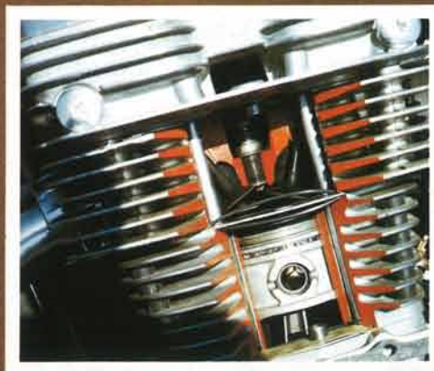
左横から見た燃焼室。ピストンリングは圧縮2本、オイル1本である
