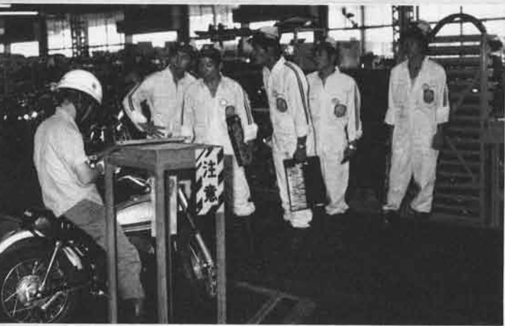
完検、すなわち完成車検査。組立てを終わった製品 は一車一車すべてエンジンがかけられ検査される
