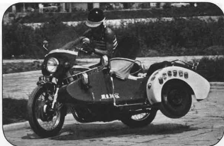
① サイドカーの運転は、いかにカーとのバランスをとるかということ。倒れないからといって急激にカーのほうにハンドルをきると、曲がりきれずに、カーがかくのごともちあがって危険。転倒さえ招くが……
