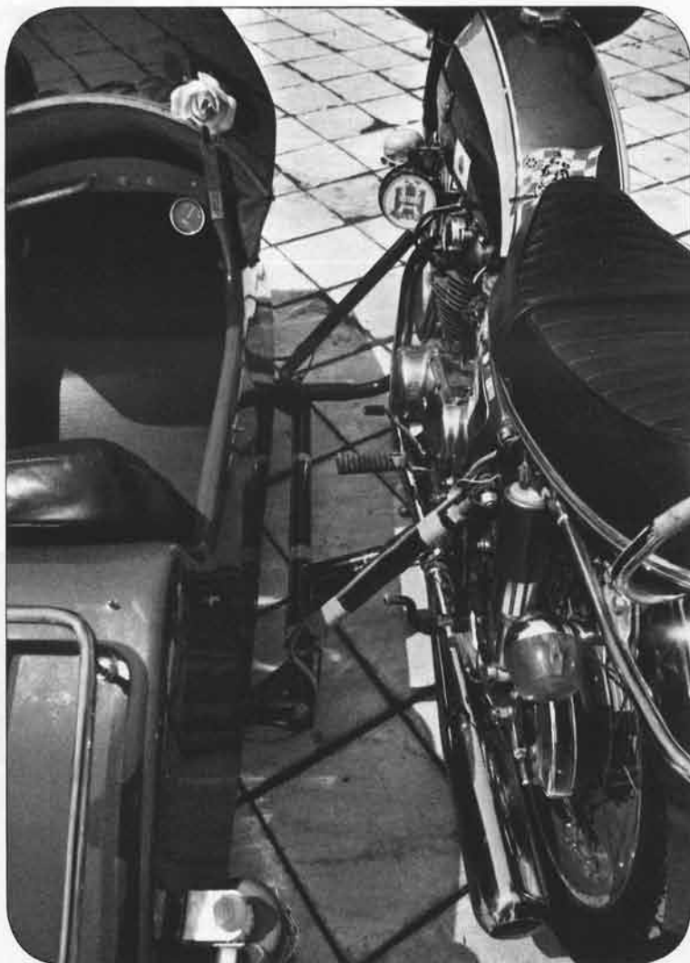
小林さんの太田製サイドカーは、ジョイントを固定式としたレーシングタイプ。カーの取付けはトーイン（カー車輪が進行方向にむけて内側に向いている角度）、リード（カー車輪と後輪との取付位置の前後方向の相違距離）、キャンバー（カー車輪が垂直より外側に傾斜している角度）など、基本設計にいろいろなむずかしさがある。
