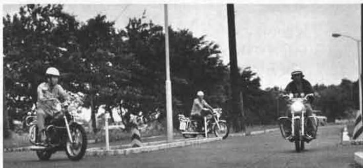
ブレーキ技能テスト。試験車両と同じようにブレーキをかけるとヘッドライトがつく。
