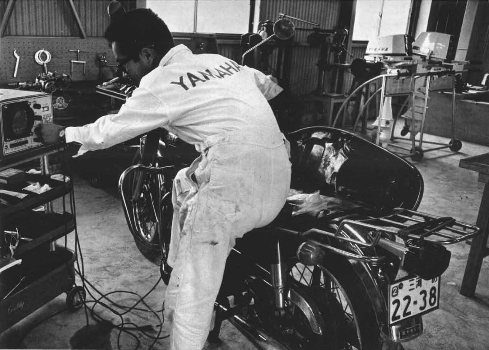
点火、充電など、電気まわりはモータースコープが威力を発揮。ブラウン管に示される波形で良否は即座にわかる。
