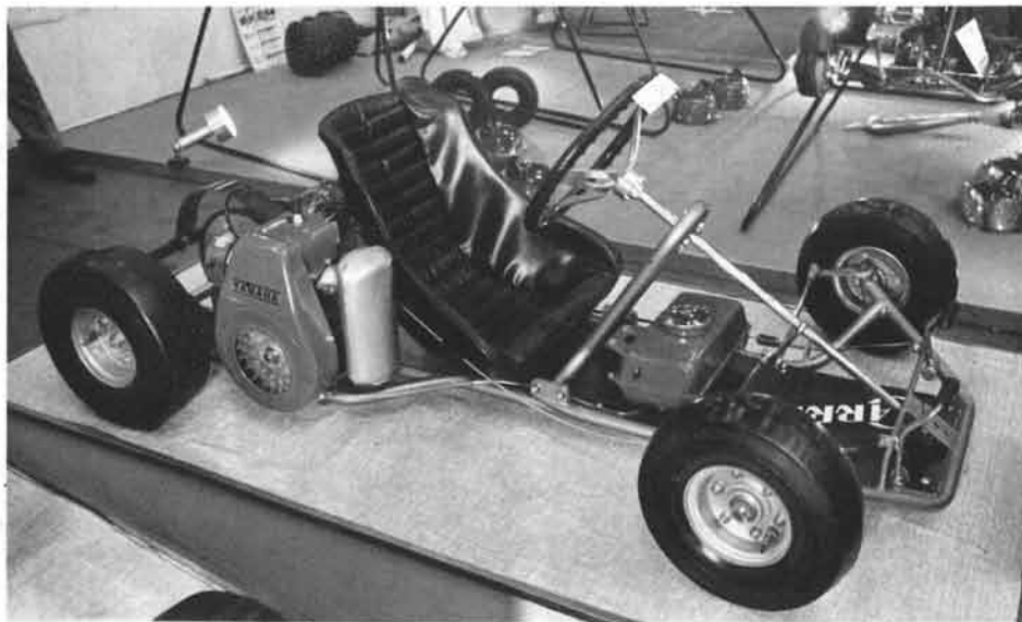
ヤマハ汎用エンジンMT110をのせた「カーレルB-STD」 全長1510mm全巾925mmトレッド800/820mm。
