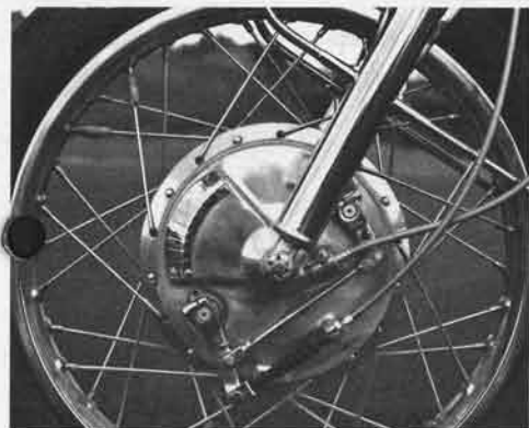
▲エア・スクープ(キャップ)付、ツインカム の強力な前輪ブレーキ。
