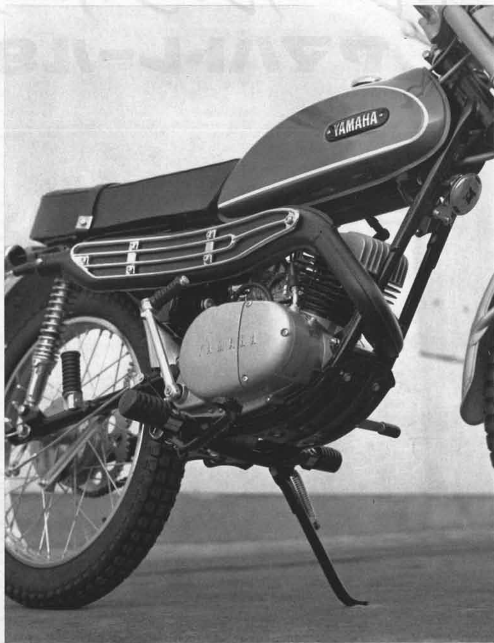
▲ボア・ストローク50×45.6mmの89ccオートループ・エンジンは、6.85：1の圧縮比で 8.5 PS/7000rpm、0.9kg-m/6500rpmの出力性能をもつ。燃費は70km/ℓ(40km/h)。
