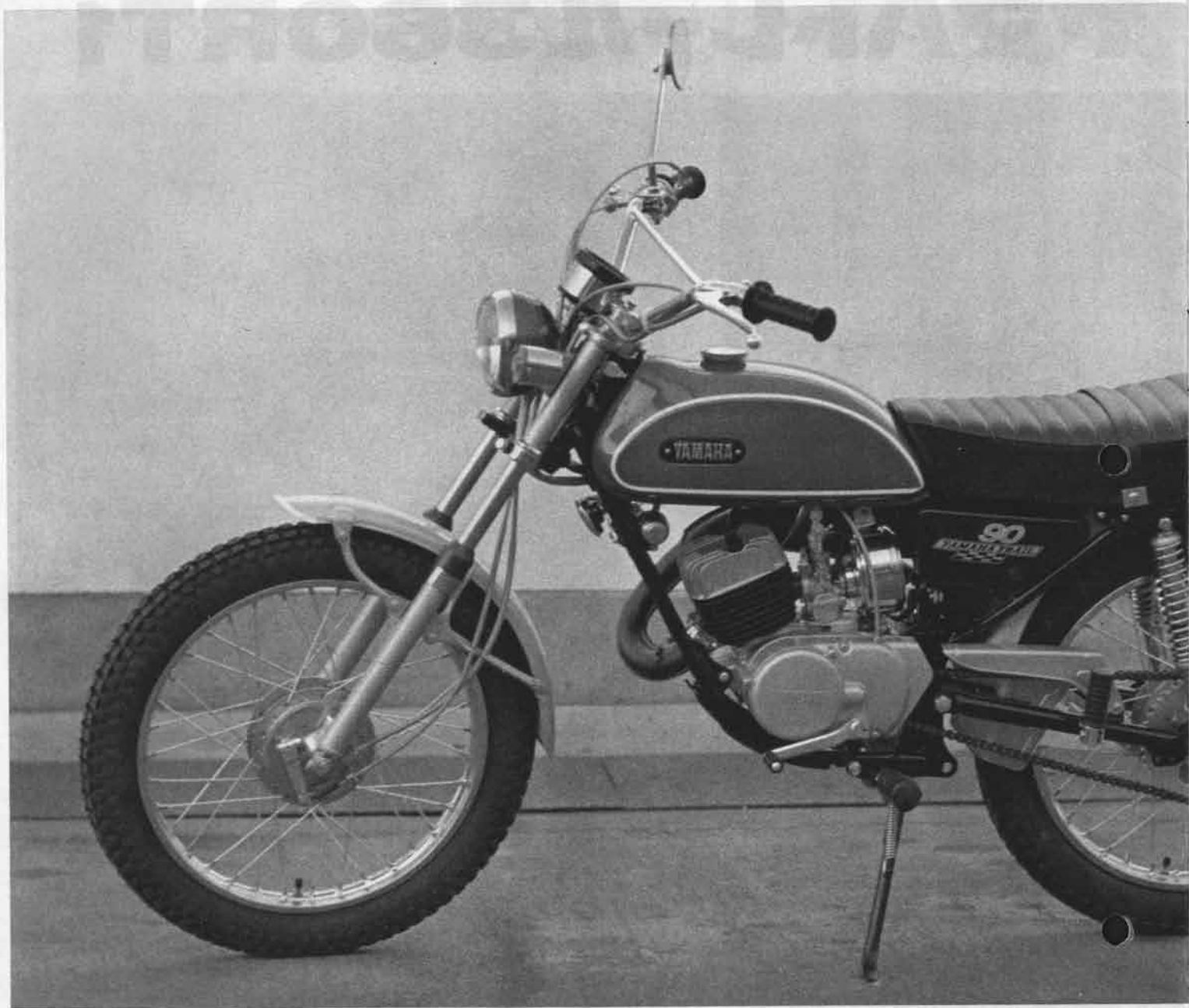
▲95km/hの最高速度性能に加えて、25度の強大な登坂力をもつ。車重は85kgと軽量で、エンジン性能をフルに引き出す5段変速機の装備も注目のマト。HTIの誕生によって、トレール走行の一般化は急速に広まるはずだ。
