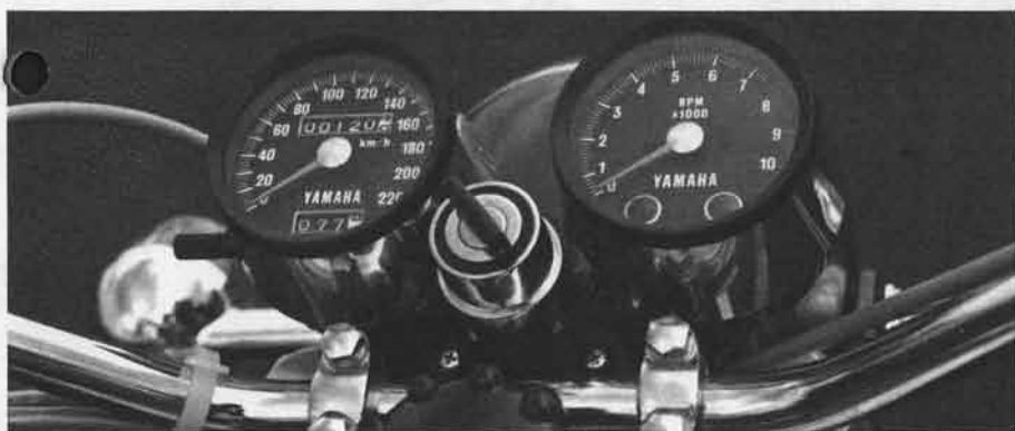
▲シャープなデザインのスPEEDメーターとタコメーター。中央にあるのはイグニション・スイッチで、ステアリングダンパーもある。
