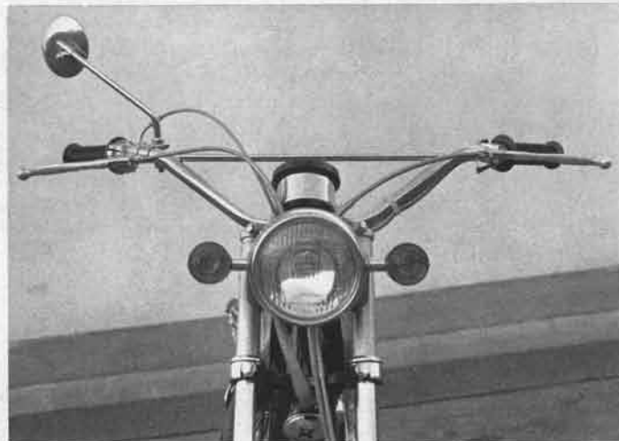
▲ブリッジ付の巾広なアップハンドルはオフ・ロードで適切なハンドリングをもたらす。
