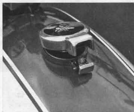
▲ワン・タッチで開閉できる燃料タンクのキャップ。タンク容量は12.5ℓ。
