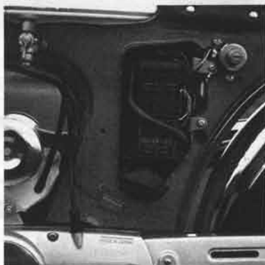
▲ツールはバッテリーの下に格納される。バッテリーはコンパクトな6V
