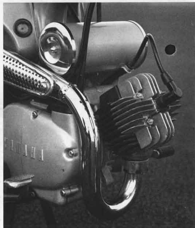
▲エンジンはロータリーバルブ、6.0馬力、オーバースクエアで9,000回転の高速エンジン。
