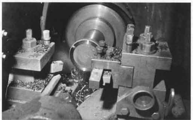
8 機械加工の第一工程は、ウエブの端面旋削と両端のセンター孔加工を専用機で加工します。
