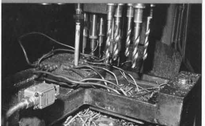
11 専用機で、クランクピン孔、バランス孔の荒加工穴あけをします。(一度に5～6個のクランクを加工します)
