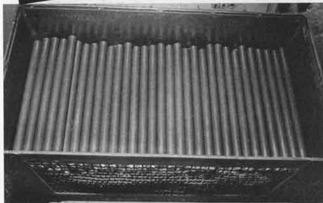
1 クランクシャフトの素材。ごらんのように丸い鋼棒です。
