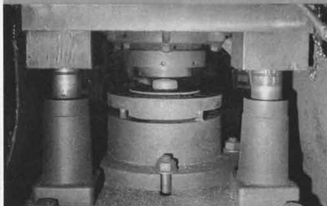
6 マイプレスはドイツ製のプレス盤で、実に600tというすごい力です。普通自動車のボディなどをつくるプレスが300tですからそのすごさがわかります。
