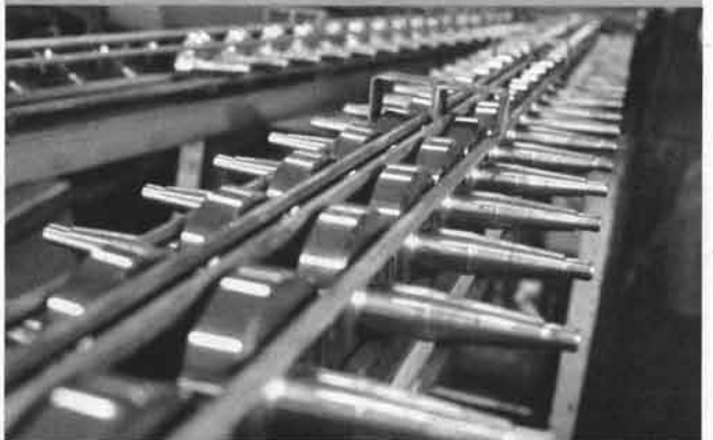
10 次の工程のクランクピン穴あけに移すためローラーコンベアで速やかに移動させます。
