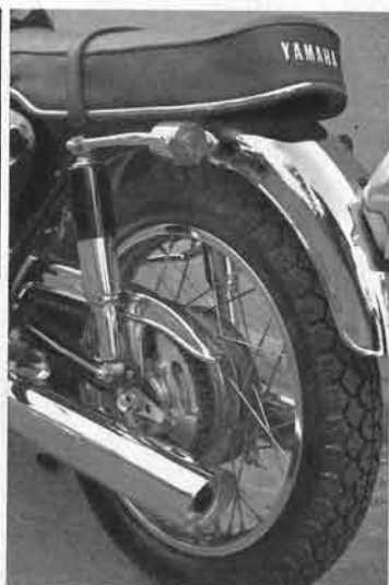
⑤タイヤは新型トレッドパターンの高速用のもので、後輪は3.50-18とひとまわり大きくしてある。またリヤ・クッションはそのバネ圧を3段階に調節することができる。
